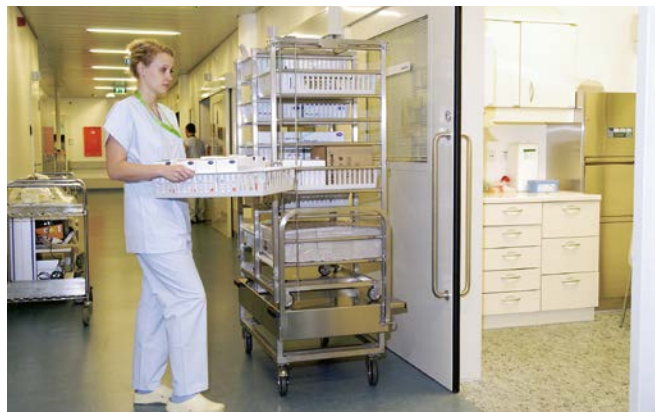
FTS-Shuttle-Einheit bei der Verteilung auf der Station
