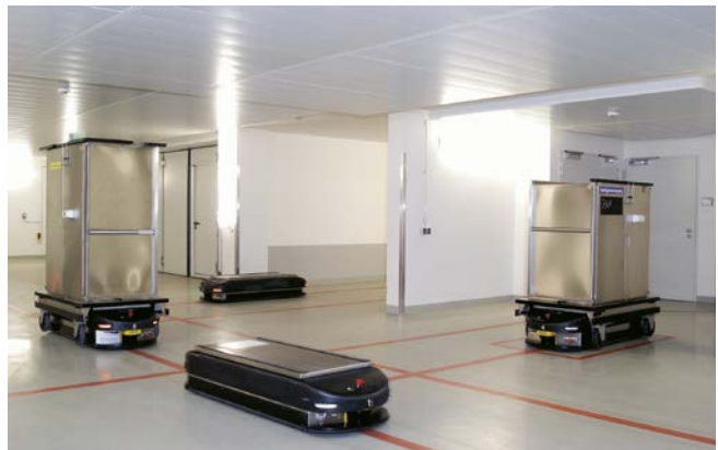
FTS-Transporteinheiten fahren selbstständig zum Ziel
