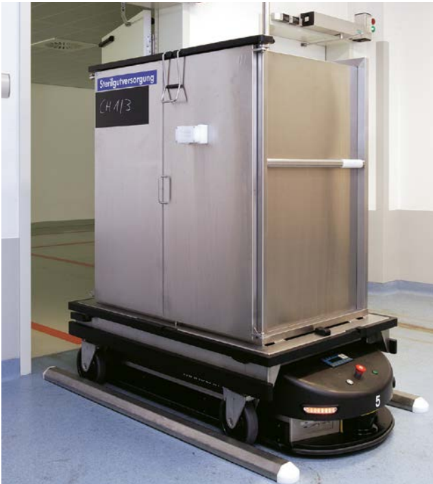
FTS-Transportwagen wird vollautomatisch abgeholt
