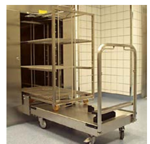
Einfahren eines 2-Wege-Einschubgestelles in den Sterilisator
