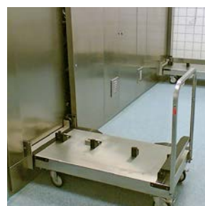
Andockung eines Übernahmewagens an den Sterilisator
